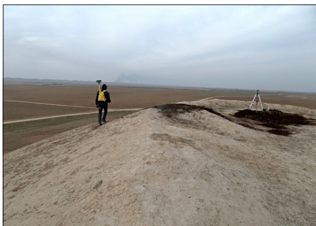
Fig. 4 – Master Station sulla sommità del mound principale (Master Station P1).
