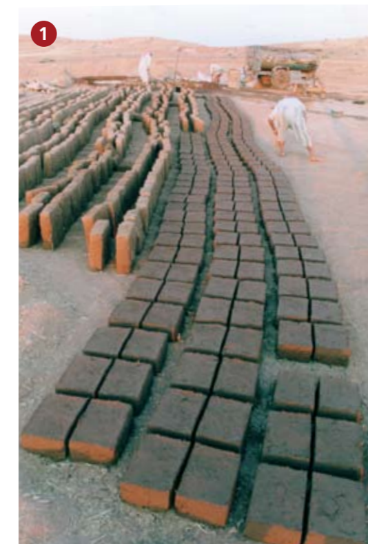
1. La preparazione dei mattoni crudi moderni per gli interventi di restauro segue la stessa tecnica usata da millenni nel Vicino Oriente. L'impasto di paglia, acqua e argilla prende negli stampi la forma del mattone che viene lasciato seccare al sole per diversi giorni. © MAIS.
