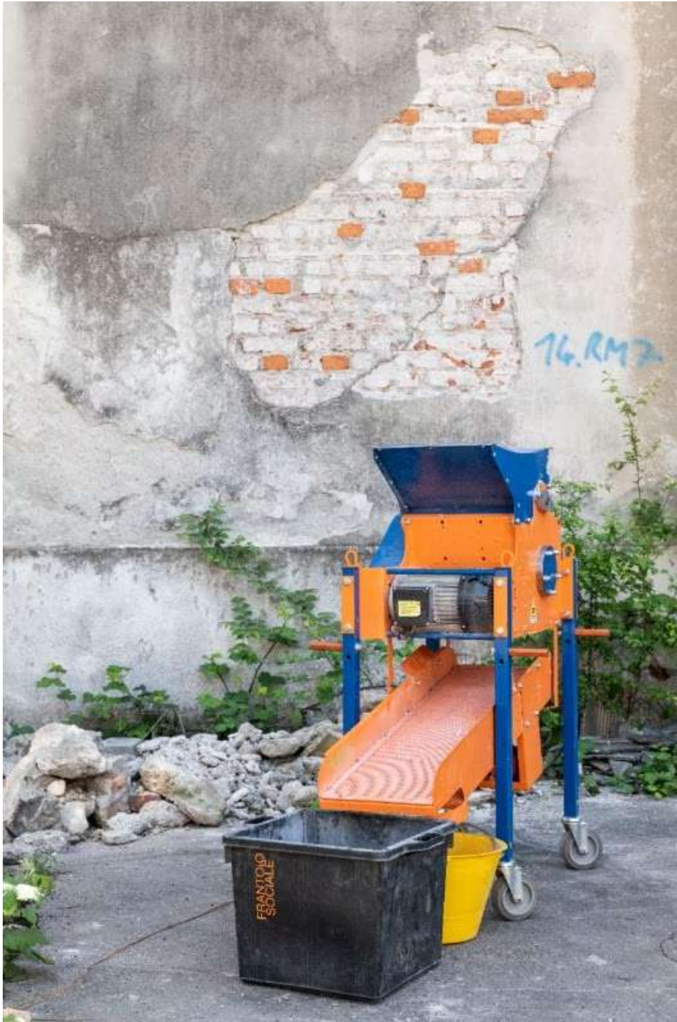
La macchina frantumatrice trasportabile, Frantoio Sociale, Studio Gisto. Foto di Daniele Ratti
